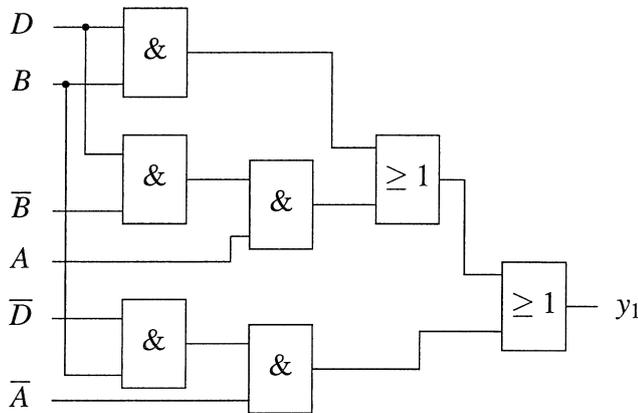
(a) Schaltnetz für die Schaltfunktion  $y_1$ .
