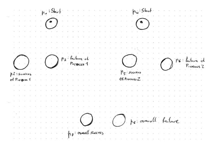
Prozess 1 und 2 bearbeiten unabhänige Aufgaben, ergänzen/vervollständigen sie das Petrinetz durch hinzufügen von Stellen, Token und Transitionen so, dass das Gesamtsystem fehlschlägt, falls Prozess 1 einmal, oder Prozess 2 zweimal fehlschlägt.
